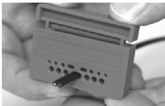
Abbildung 30: POF-Kabel mit Schneidewerkzeug
